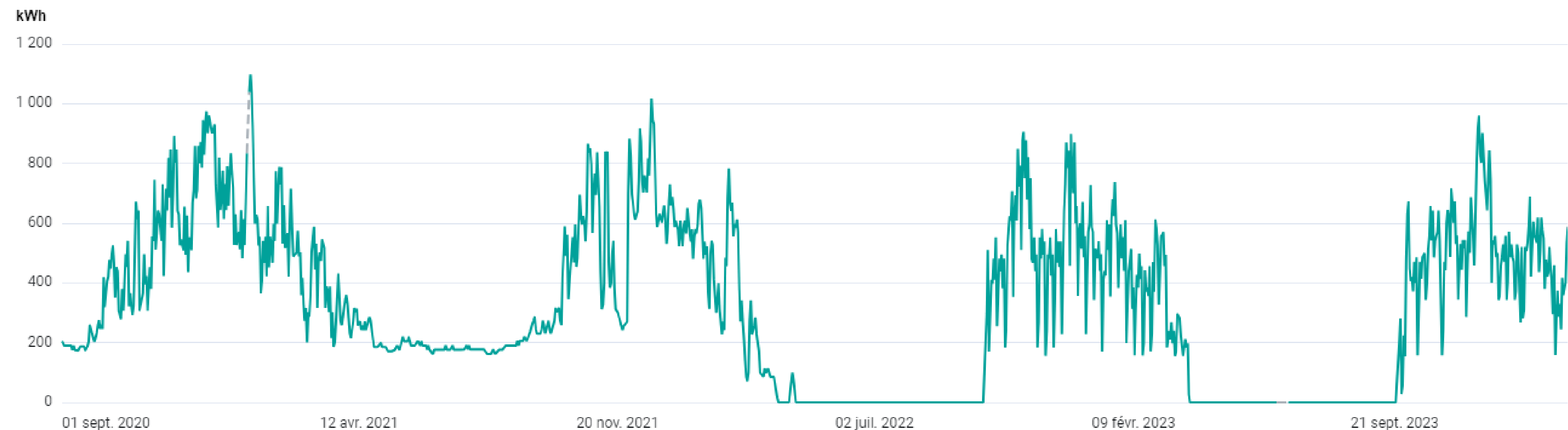
Exemple de consommations gaz suite mise en place de régulation maison de la jeunesse (Donges)
